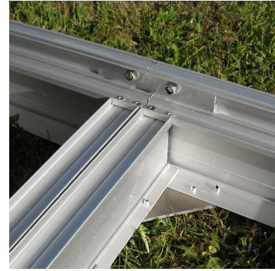
Sivukiinnike valmis, sisäpuoli.
